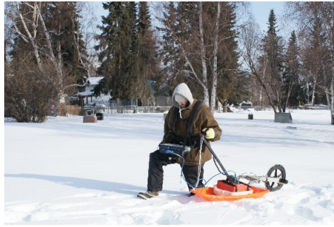
Figura 3.25: Recopilación de datos GPR en nevadas intensas. La nieve permite un buen acoplamiento de energía con el suelo subyacente, pero la energía se esparcirá en la capa de nieve y producirá reflejos menos distintos desde el punto de vista aéreo en el suelo.
