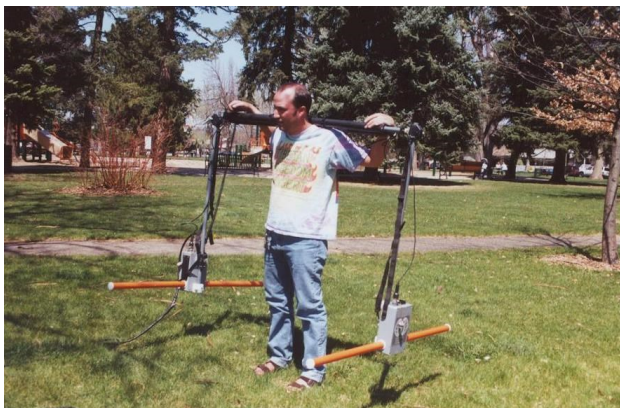
Figura 3.11: Las antenas de muy baja frecuencia casi siempre están sin blindaje y deben ser transportadas por el suelo por una o más personas. Esta antena GSSI puede producir energía de frecuencia central que varía entre 16 y 100 MHz según la configuración y la separación de la antena.
